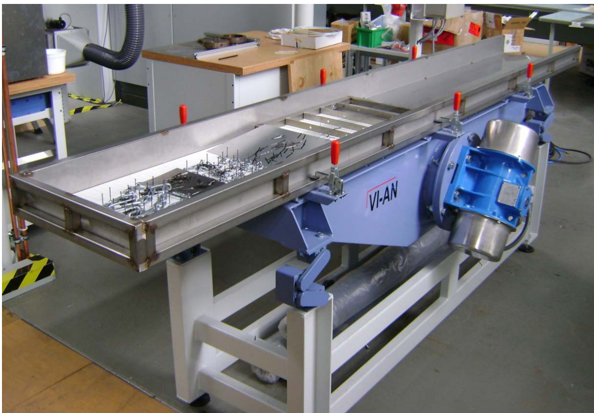
Abbildung 2: Vibrationsanlage mit Versuchsaufbau zum Auflösen der Gewebestruktur zu einzelnen Stapelfasern
