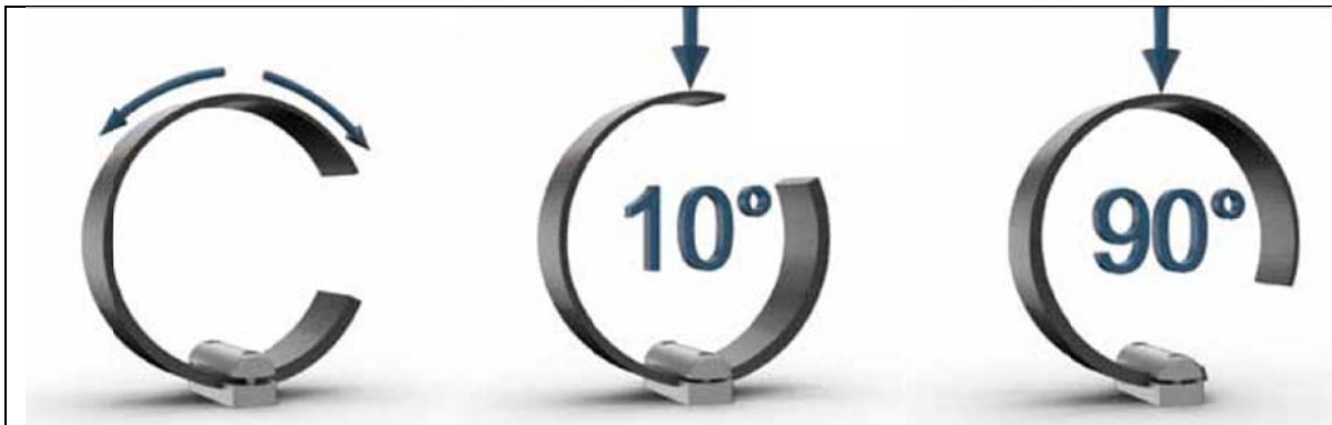
Abbildung 1: Funktionsprinzip der teilkreisförmigen Schneckenblattfeder: Durch Drehen der Feder in seiner Lagerung verändert sich die Federhärte durch die unterschiedlichen Lagendicken vertikal gegenüber liegender Federbereiche. Bei Wahl einer feinen Abstufung des Lagenaufbaus ergeben sich sukzessive veränderliche Bauteildicken und damit zwischen der Ober- und Untergrenze quasi eine unendliche und einstellbare Variation der Federsteifigkeit.
