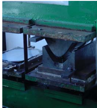
Hydraulikpresse mit Werkzeugen bestückt
