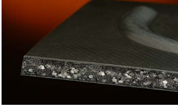
Curv/ePP Schaum Laminat mit leichter Rippenverstärkung hergestellt in einem Prozess (one shot process)
