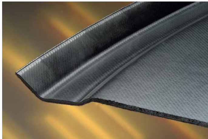
Curv/ePP Schaum Laminat mit komplexerer Geometrie (Kanten sind werkzeugbedingt komplett verpresst)
