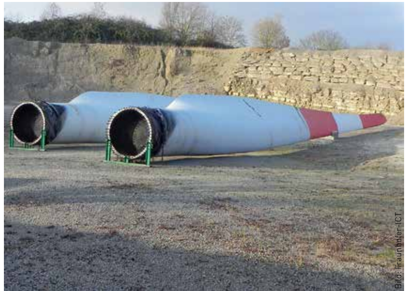
Abmontierte Rotorblätter einer durch Blitzschlag zerstörten Windkraftanlage. Bald werden nicht mehr nur einzelne Unfälle der Grund dafür sein, dass diese GFK-Riesen ab und an beseitigt werden müssen: denn die erste Generation von Anlagen hat bald ausgedient.
