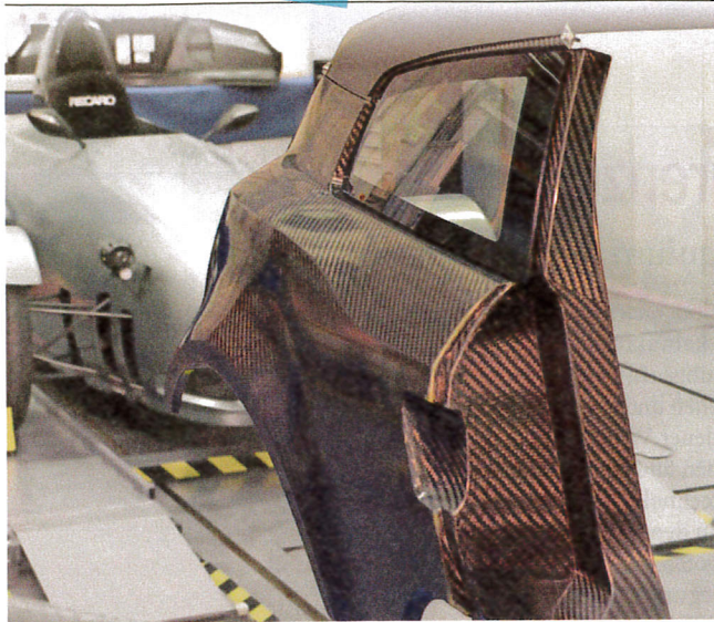
Seitenteil eines Konzeptautos (In Eco) mit integrativer CFK-Stahl-B-Säule, hergestellt im RTM-Verfahren Foto: TUD
