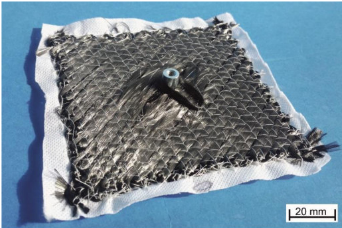
Preform mit integriertem Insert durch Tailored Fibre Placement (Quelle: ITA)
