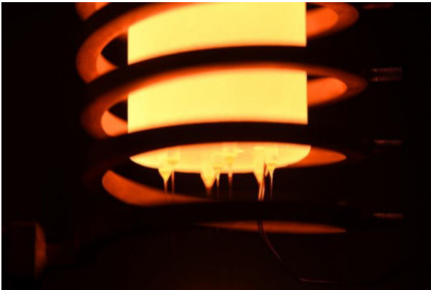
Induktiv beheiztes Bushing der neuartigen Glasfaserspinnanlage, Quelle: ITA
