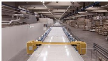
Die LAMILUX Composites GmbH ist spezialisiert auf den kontinuierlichen Herstellungsprozess von glasfaserverstärkten Kunststoffen.
