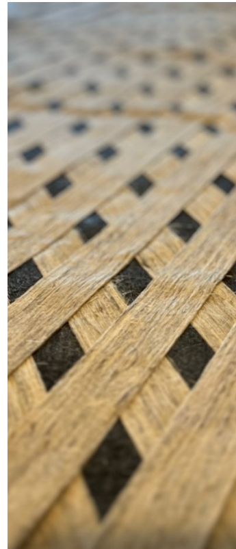
Abb. 3: Preform mit Hanffaser- und rCF-Tapes
