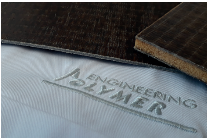
Abb. 2: Vollständig biobasiertes Sandwich als Demonstratorbauteil
