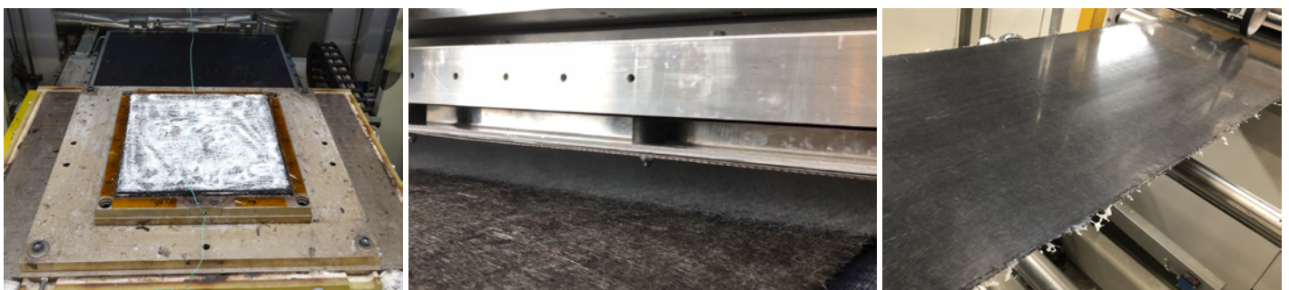
Abb. 2: Manuelle Pulverimprägnierung am IGCV für Testplatten, die das verstreute Pulver vor dem Heißpressen zeigen (links), automatische Pulverimprägnierung (Mitte), Organoblechproduktion (rechts) [1]
