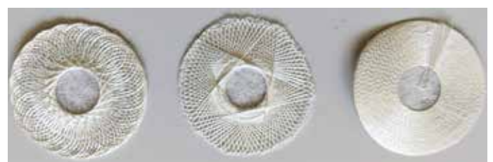
Abb. 3: Im TFP-Verfahren hergestellte textile Verstärkungsstrukturen
